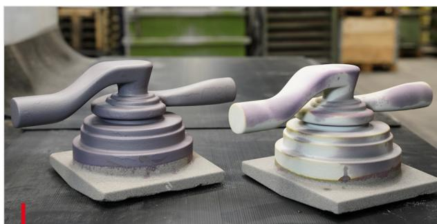
Deutlich – Schlichteschicht Nass vs. Trocken – Der Farbumschlag ist reversibel, d.h. kann Feuchtigkeitsaufnahme anzeigen.
